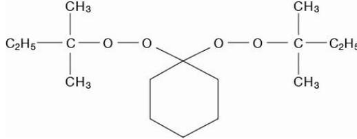
在升温条件下, Trigonox 122-C80 是高效的不饱和聚酯树脂和乙烯基树脂固化剂。典型的应用包括预浸料, 预混料, BMC, TMC, SMC和拉挤成型工艺。在BMC和SMC模塑料中, Trigonox 122-C80 可提供较长时间的存放期。
